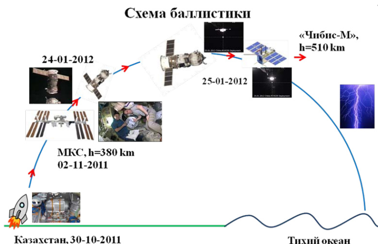
Рис. 1. Схема вывода «Чибис-М» на орбиту в инфраструктуре Российского сегмента МКС.
