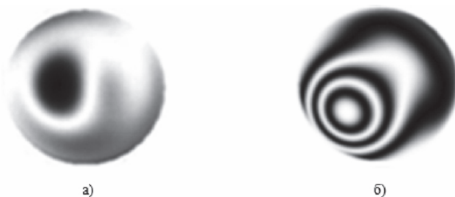
Рис. 1. Интерферограммы функций отклика зеркал: на пьезоприводах (а); биморфного (б)
