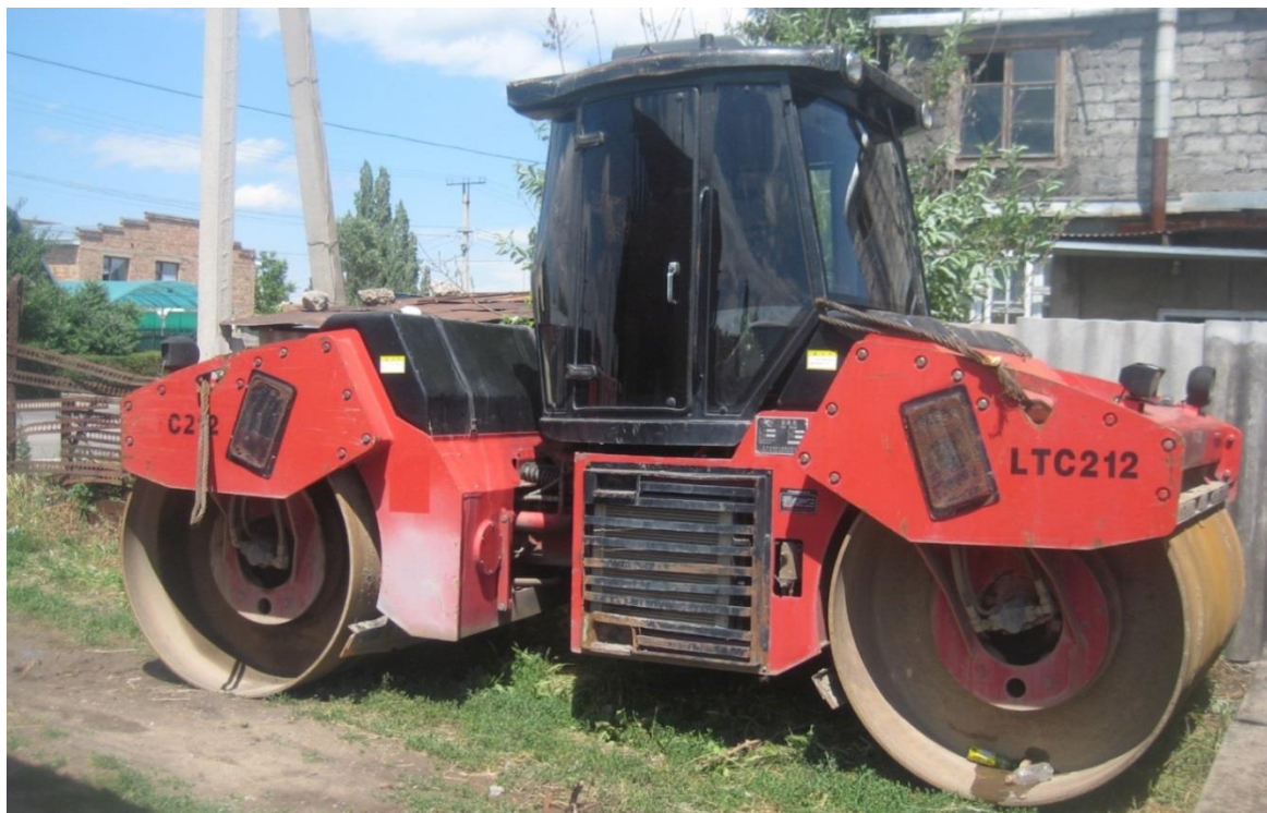
Рисунок 4.8. Использованная вибромашина модели LTC212
