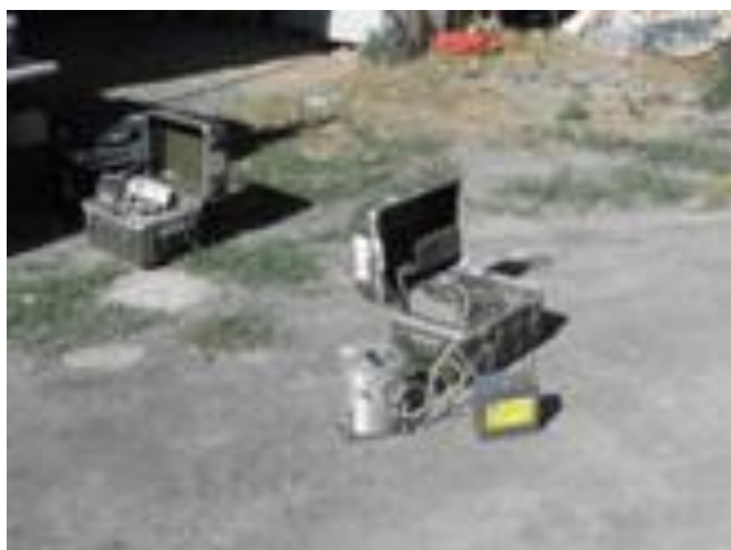
Рисунок 3.23. Фотодокумент установки сейсмостанции для проведения мобильных измерений
