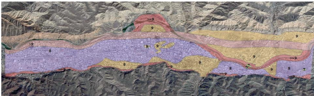
Рисунок 3.22. Карта сейсмического микрорайонирования территории города Нарын (1976 г.): а. на бумажном носителе; б. оцифрованная.
