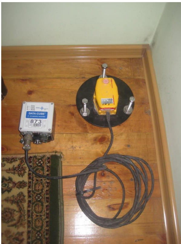
Рисунок 4.7. Пример инструмента, используемого для исследования шума. Каждая станция оснащена 24-битным регистратором данных CUBE, подключенным к сейсмоприемнику Геофон 4,5 Гц (желтого цвета)
