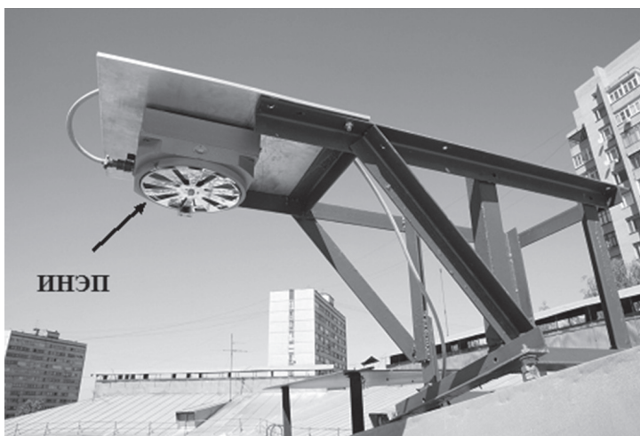
Рис. 3. Расположение флюксметра ИНЭП на установочной площадке
