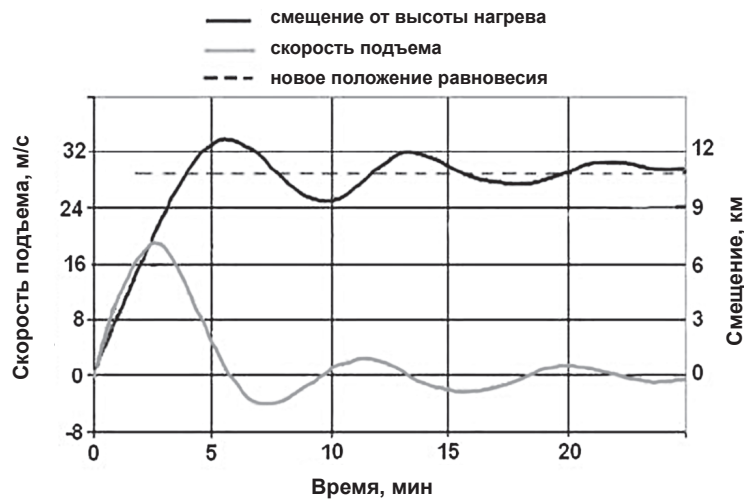
Рис. 4. Зависимость от времени смещения и вертикальной скорости области газа, нагретой на начальной высоте 110 км.
